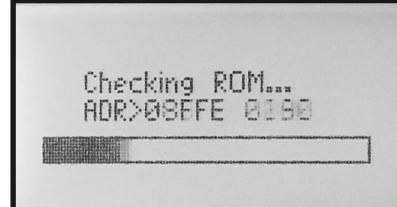
1. Nach dem erstmaligen Einstecken des Netzsteckers an das Stromnetz, lädt das Steuergerät aus dem Speicher einen vorgegebenen Programmablauf zur Initialisierung. Vier Informationseinheiten müssen manuell hinterlegt werden, um die Betriebsbereitschaft herzustellen.
