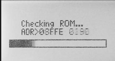
1. Lors du 1er raccordement électrique, le système s'initialise durant quelques secondes, puis le rétro-éclairage s'éteint et l'afficheur laisse apparaître le menu suivant.
