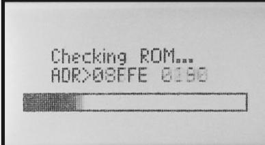
1. Po pierwszym podłączeniu wtyczki do gniazda sieciowego urządzenie sterownicze ładuje z pamięci program mający na celu inicjalizację. Cztery jednostki informacji muszą zostać wprowadzone ręcznie, aby urządzenie znalazło się w trybie gotowości do działania.
