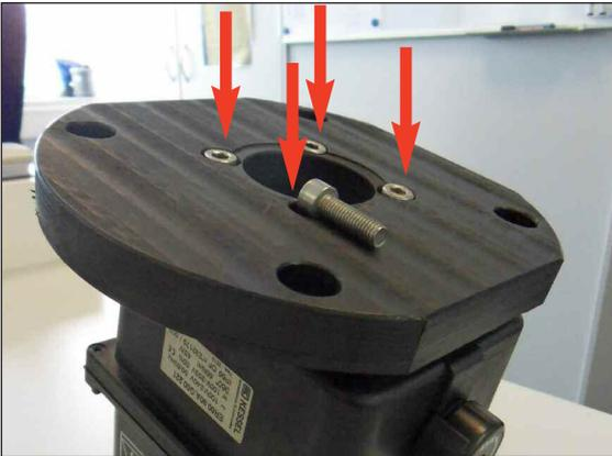
D: Motor und Adapterplatte mit vier Schrauben (5 Nm) verbinden und auf Ventil aufsetzen.
