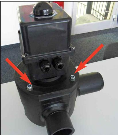
D: Mit mindestens zwei Unterlegscheiben und Muttern (5 Nm) sichern.
