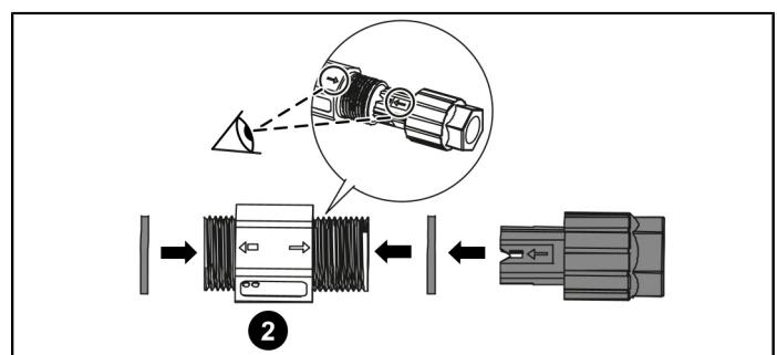
De kabel (eventueel via een mantelbus) aansluiten. Hiervoor het beschermkapje verwijderen (1), een passende stekker kiezen (kleurcodering van de afstandsring) en "pil op pil" of "punt op punt" uitlijnen (2). De stekkers vastdraaien (3) en daarbij de aangebeelde tussenruimte en aandraaimoment in acht nemen.
