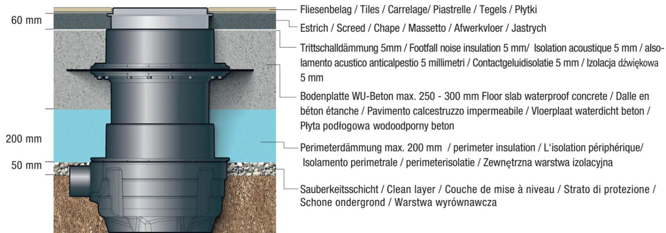
**Maximale Wärmedämmung über der Bodenplatte mit zusätzlicher Verlängerung / Maximum thermal insulation above the floor slab with an additional extension / Isolation thermique maximale au dessus de la dalle avec rallonge / Isolamento termico massimo sopra il pavimento con prolunga aggiuntiva / Maximale thermische isolatie boven de vloerplaat middels verlenging / Maksymalna izolacja cieplna nad płytą podłogową z dodatkową przedłużką (\*)**
