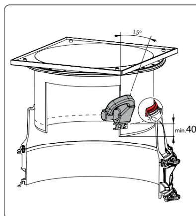
DE: Kürzen des Aufsatzstückes, Aufsatzstück nach Kürzen anfasen. Das Aufsatzstück ist ggf. auf die erforderliche Höhe zu kürzen. Zum Kürzen des Aufsatzstückes so anzeichnen, dass das Aufsatzstück mindestens 40 mm in das Verlängerungsstück eingesteckt werden kann. **Achtung:** Mindesteinstecktiefe beachten!
