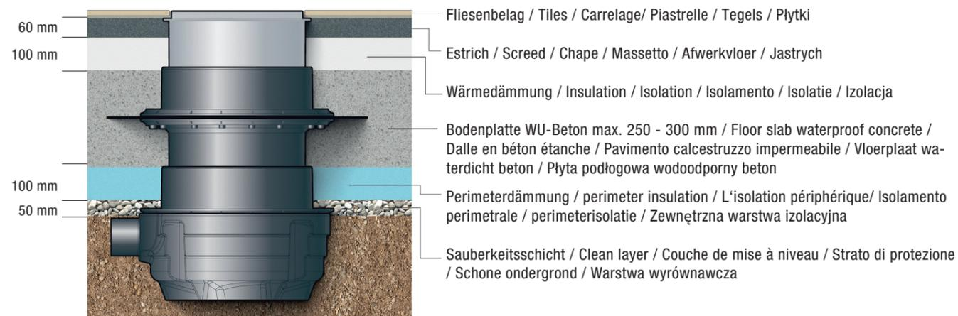
**Wärmedämmung unter der Bodenplatte (Perimeterdämmung) / Thermal insulation under the floor slab (perimeter insulation) / Isolation thermique sous la dalle (isolation périphérique) / Isolamento termico sotto il pavimento (isolamento perimetrale) / Thermische isolatie onder de vloerplaat (perimeterisolatie) / Izolacja cieplna pod płytą podłogową (izolacja zewnętrzna)**
