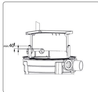
DE: In manchen Einbausituationen muss das Aufsatzstück im Bereich der Kabeldurchführung ausgespart werden.
