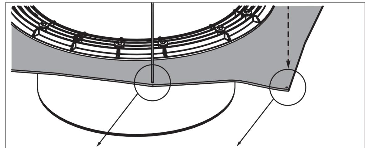
DE: Mit Fixierung ist die Dichtbahn gerade.
