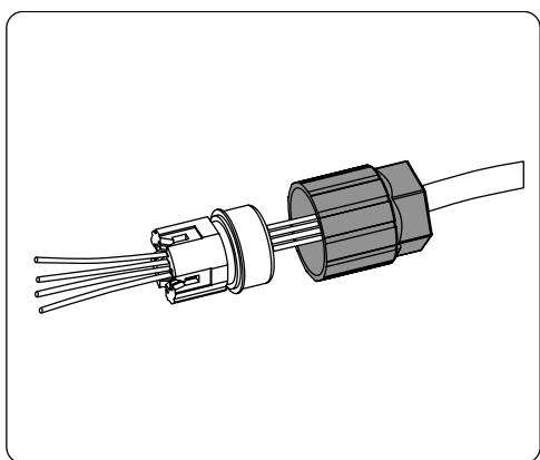
DE: Sicherstellen, dass Adern ca. 40mm aus der Kabelummantelung herausragen. Mutter überziehen, Spleißbody des Schraubverschlusses bis zum Anschlag aufschieben.
