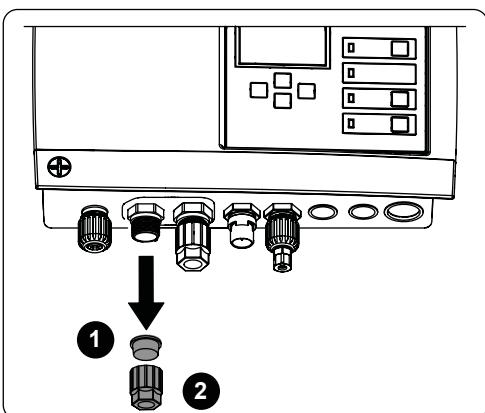
DE: Mutter(n) vom Schraubverschluss abschrauben ①, Blindkappe(n) herunterziehen. ②
