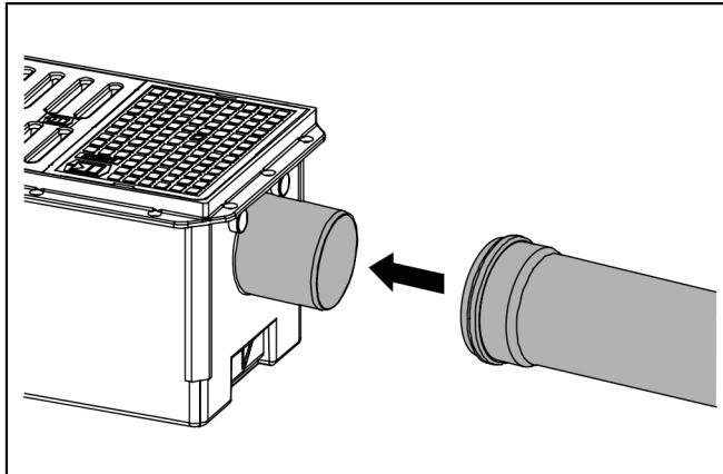
① Abdeckplatte dient zugleich als Bauzeitenschutz.
