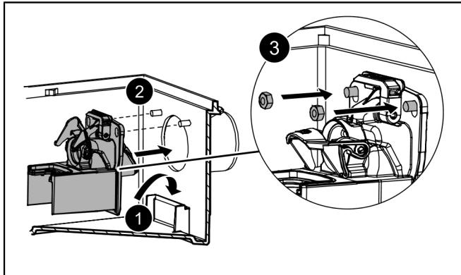
① Sicherstellen, dass der Schwimmerschalter frei nach unten hängt (Ruheposition).
