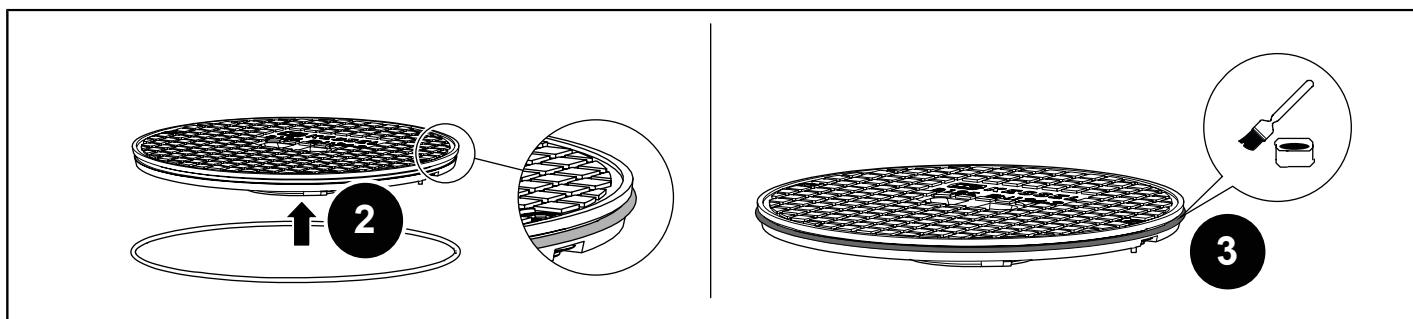
KESSEL-Abdeckplatten und die entsprechenden O-Ringe sind in zwei verschiedenen Geometrien verfügbar. Für die Montage der O-Ringe wie folgt vorgehen:
