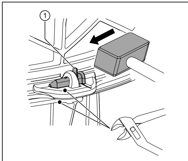
**4.6 Verlängerungsstück montieren (optional bei vertieftem Einbau des Fettabscheiders)**
